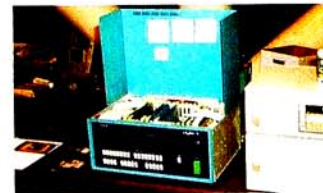
Ən birinci mikroEHM-lərdən olan Intel 8080 prosessoru əsasında qurulmuşdu, təqribən 2,5 min dollar dəyərində idi.
