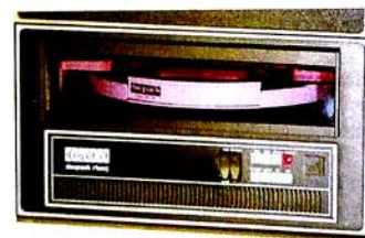
PDP-11-in 2.5 Mbayt tutumlu dəyişdirilə bilən maqnit diskinin disk sürünü.
