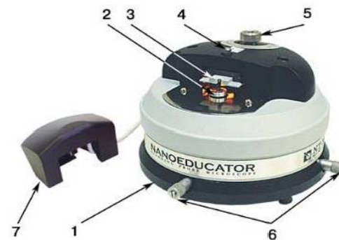
Şəkil 7-18. SZM NanoEducatorun ölçən başlığının xarici görünüşü: 1 - əsası; 2 - altıq; 3 - qarşılıqlı təsir çeviricisi; 4 - çeviricini nizamlayan vint; 5 - əl ilə gətirmə vint; 6 - nümunə ilə birlikdə skanedicinin yerdəyişmə vint; 7 - kamera ilə birlikdə qapaq.
