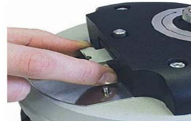
Şəkil 8-21. Zond çeviricisinin yerinə qoyulması.
