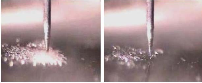
Şəkil 4-27. Qələvi məhlulun səthi ilə zond (solda) arasında elektrik cərəyanı keçən zamanı “qaynama” prosesi. Zond iynəsinin hazırlanmasından sonra “qaynama” prosesinin sönməsi momenti (sağda).
