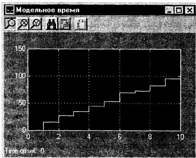
Рис. 4.36. Отображение модельного времени в блоке Scope
