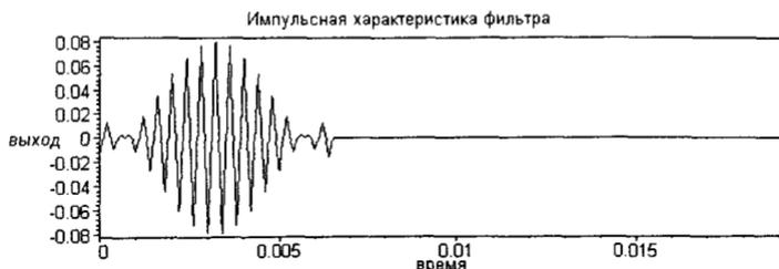
Рис. 17.19. Импульсная характеристика цифрового фильтра
