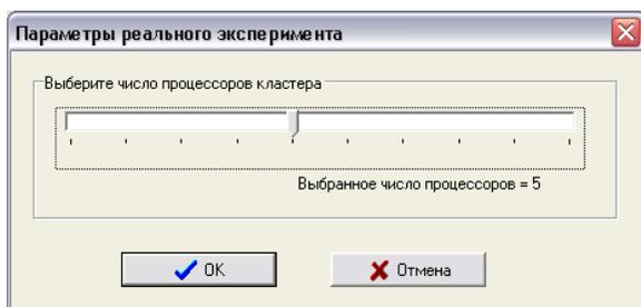
Рис. 24. Окно выбора количества вычислительных узлов
