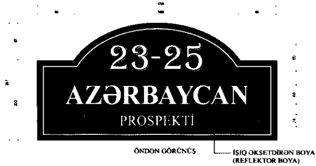
Şəkil 47, 48. Ünvan lövhələrinin layihə elementləri
