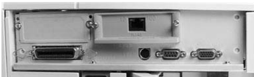
Şəkil 93. Lazer çap qurğularında olan müxtəlif əlaqə portlarının görünüşü
