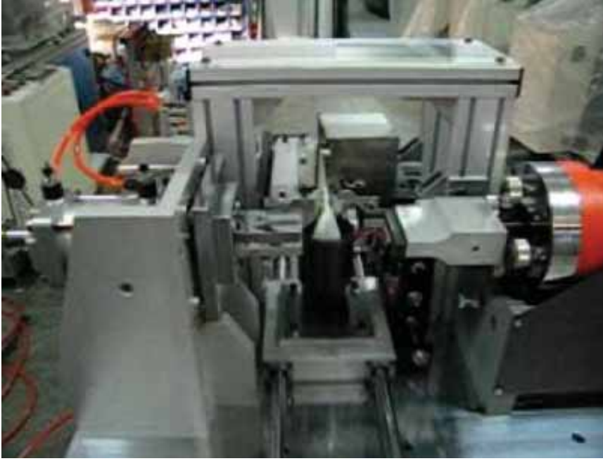
Nəfəsi musiqi alətinin mis borusunun ultrasəs qaynaq qurğusu ilə qaynaq edilməsi.
