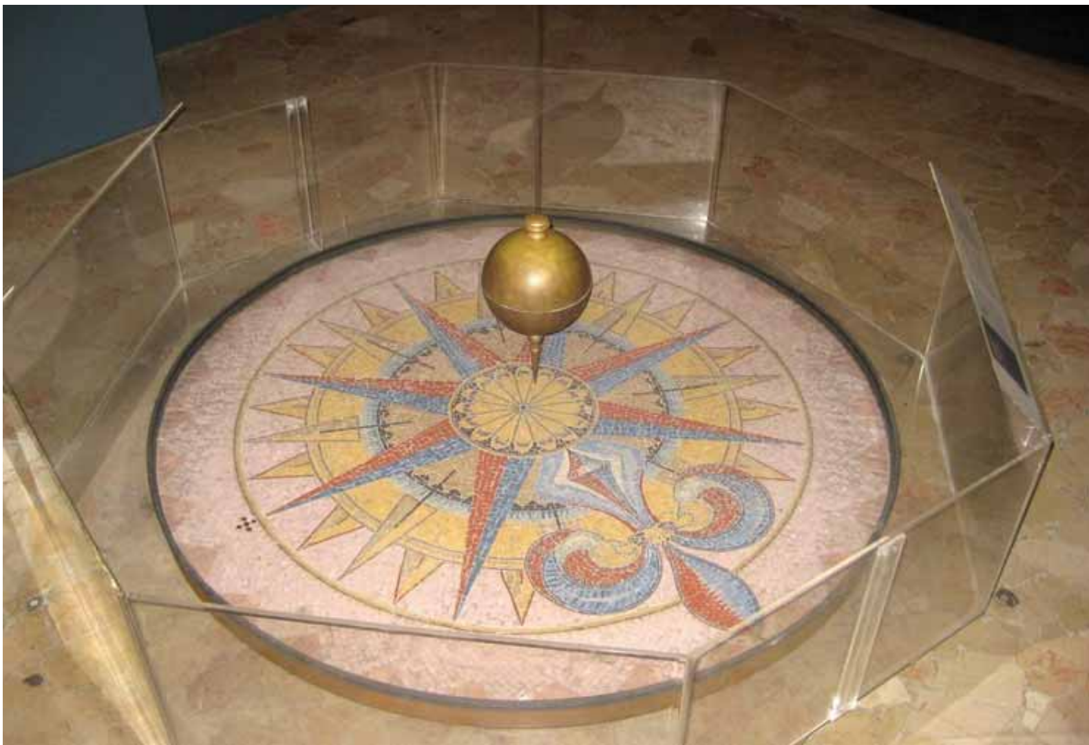
Fuko rəqqasının tuncdan tökülmüş 54 kiloqramlıq kürələri.
