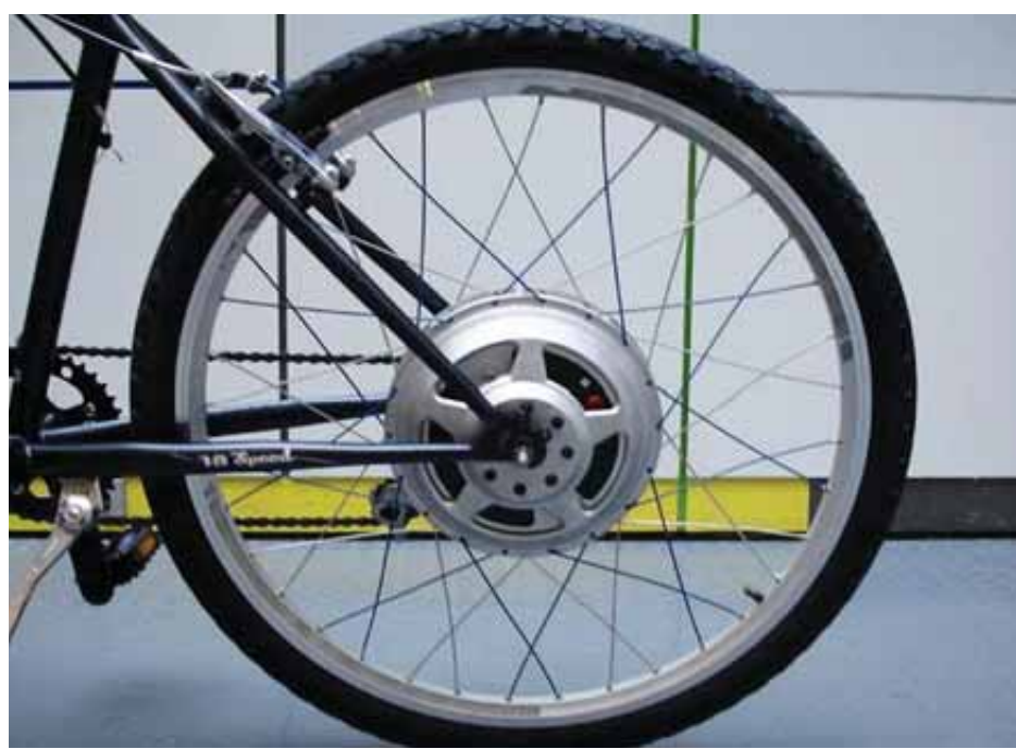
Müstəqil elektrik təkəri.
