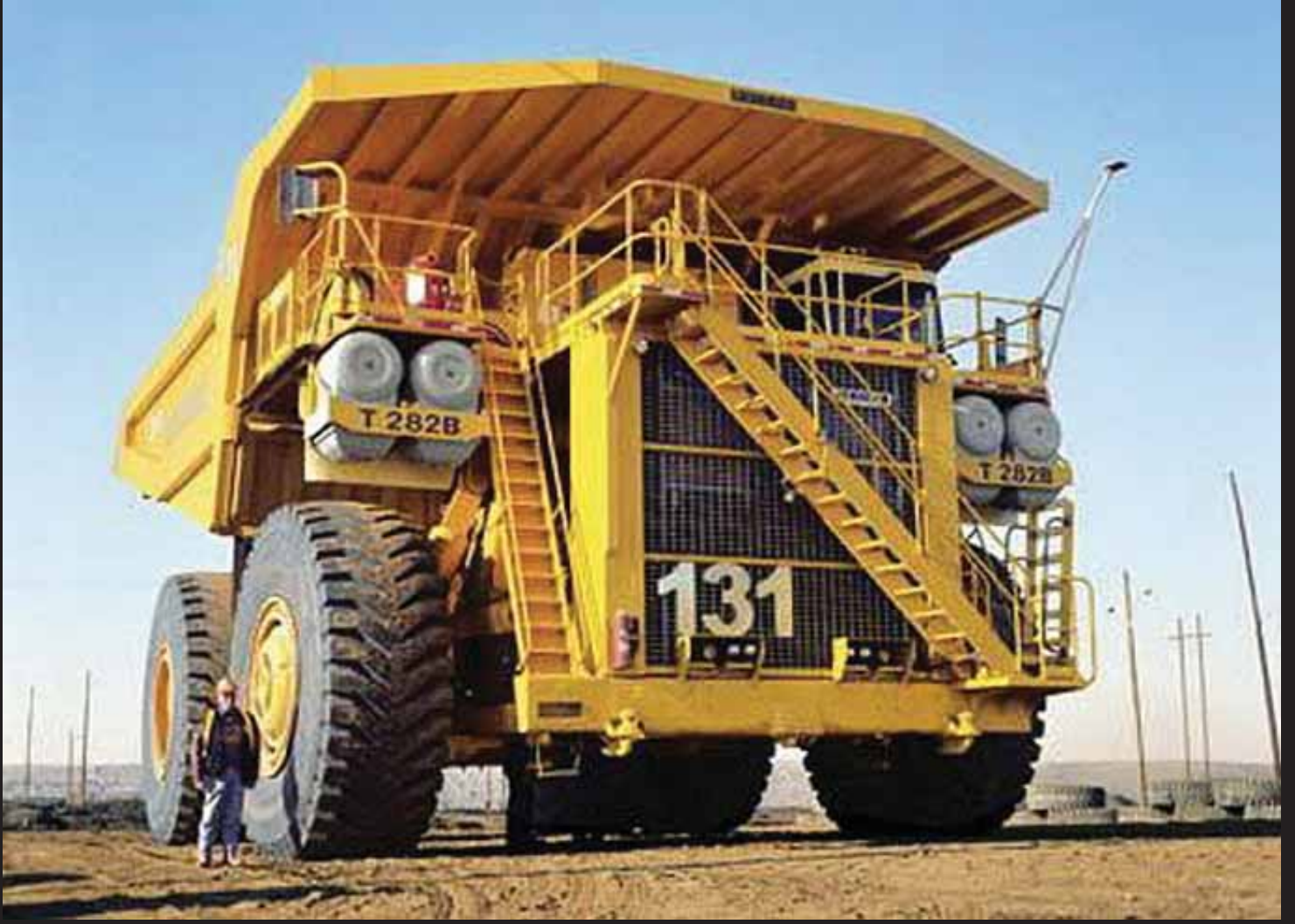
AFR-də istehsal olunmuş dünyanın ən böyük yük maşını – LIEBHERR T282B . Onun uzunluğu 14,5, eni 9 və hündürlüyü 7,4 metrdir. Maşının yükləmə qabiliyyəti 592 tondur.
