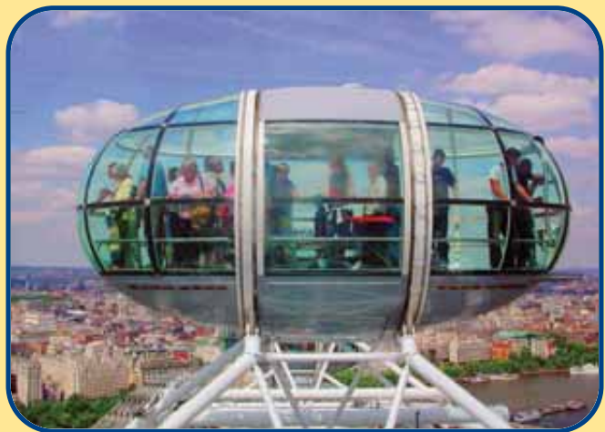
Londonun gözü seyretmə təkərinin kabinəsi. Onun çəkisi 10 ton, sənişin tutumu isə 25 nəfərdir.
