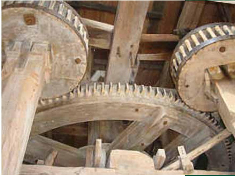
Qədim dəyirməndə ağacdan hazırlanmış dişli ötürmə.
