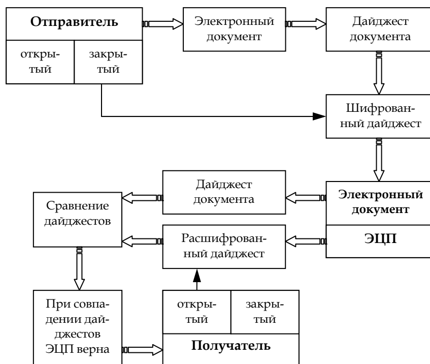
Рис. 6.6. Технология электронной цифровой подписи
