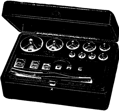
Şekil - 14 : Standart ağırlıkların yerleştirildiği tartım kutusu ve ağırlıkların alınıp konulmasında kullanılan özel pens.
