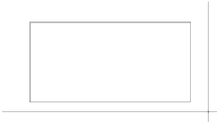
Рис. 4.6 ▼ Линии внутреннего угла сопряжены
