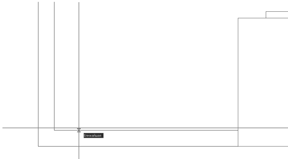
Рис. 7.20 ▼ Выбор первой точки линии с использованием режима привязки Ближайшая (Nearest)
