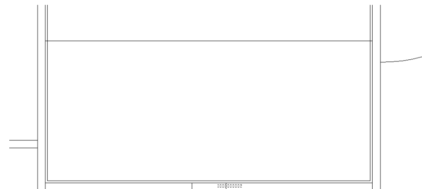
Рис. 4.60 ▼ Выделение прямоугольника с помощью пересекающей рамки
