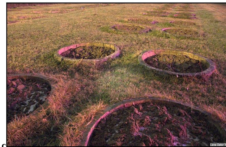
Şəkil 36. Lizimetrlər: a - Torpağa basdırılmış lizimetrin təsviri; b - Lizimetrin sxematik təsviri; c - Təcrübə sahəsində torpaqda iki sırada yerləşdirilmiş lizimtrlərin plandan görünüşü.
