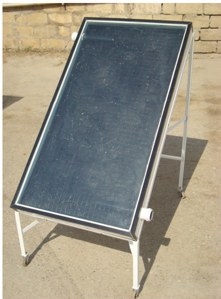
Şəkil 11.1. Kombinə olunmuş günəş havaqızdırıcı kollektoru-istilik akkumulyator qurğusunun ümumi görünüşü.
