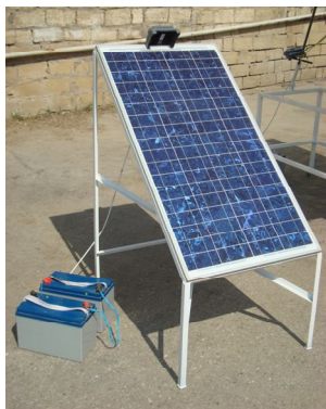
Şəkil 17.2. Fotoelementin akkumulyatorlarla və kontrollerlə birgə əyani görünüşü.
