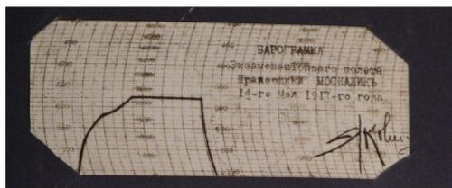
4. Подъём на высоту 500 м. и планирующий спуск, последующим выключением мотора над местом спуска, чтобы получился спуск с поворотом (контролируется при помощи максимального анероида).
