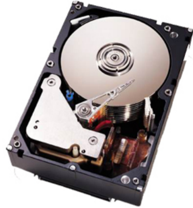
HDD (Sabit-Sərt Disk) Daxilindəki diskin görünüşü Şəkil 9.
