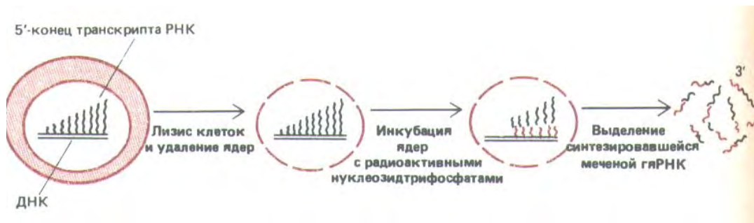
Рис. 10-3. Получение радиоактивно меченой гетерогенной РНК. Молекулы РНК-полимеразы после введения метки и лизиса клетки продолжают элонгацию тех же молекул РНК in vitro, при этом исследователь получает высокоактивный препарат тех последовательностей, которые транскрибируются в клетке (первичные транскрипты РНК).
