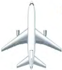
swept-back wing ala f en flecha f voilure f en flèche f Pfeilflügel M ala f a freccia f
