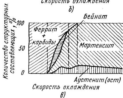
Рис. 120. Превращение переохлажденного аустенита легированной стали, обладающего высокой устойчивостью при температурах промежуточного превращения: a — кинетика изотермического превращения переохлажденного аустенита; б — влияние скорости охлаждения на температуру превращения аустенита; в — влияние скорости охлаждения на количество структурных составляющих после окончания превращения
