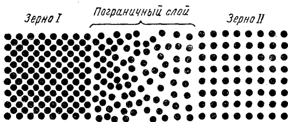
Рис. 15. Модель размещения атомов в области границы зерна металла
