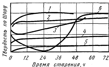
Рис. 228. Изменение твердости различных эластомеров при термическом старении при 200°C: 1 — хлоропреновый каучук; 2,3 — нитрильный каучук; 4 — бутилкаучук; 5 — силиконовый каучук; 6 — НК
