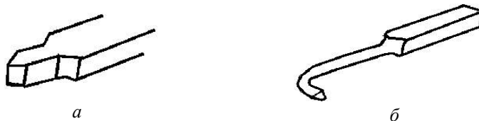
Рис. 4 Стержневые резцы для резьб: а – наружных; б – внутренних
