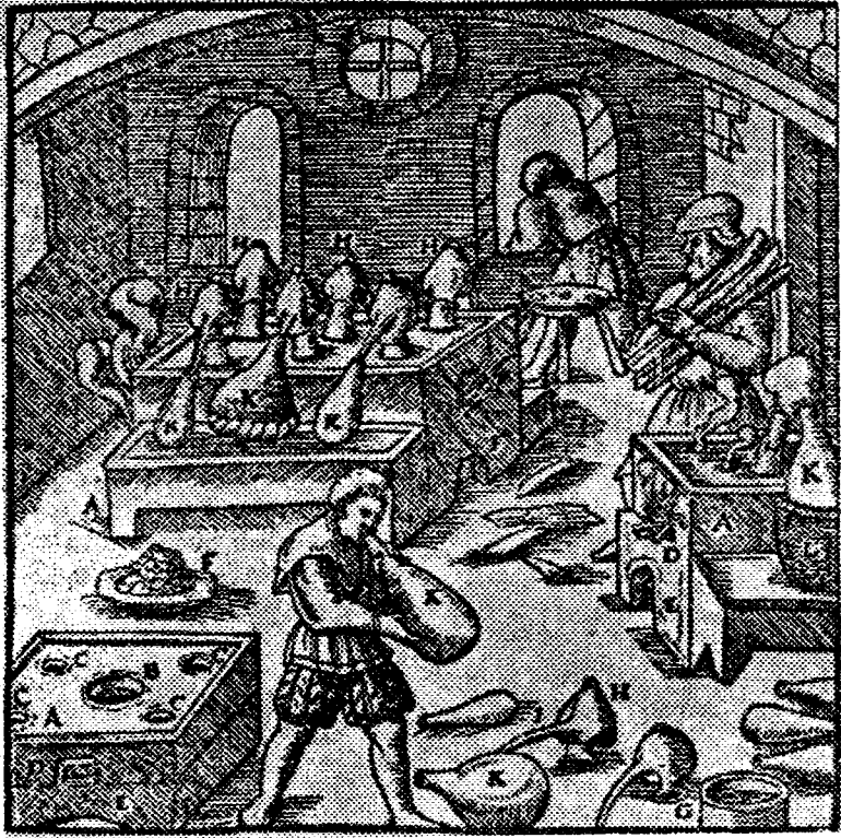
Xlorid və nitrat turşularının distillə üsulu ilə alınması (Q.Aqrikola, "Metallurgiya").
