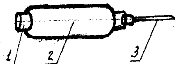
Şəkil 42.2.1. 1) tıxac; 2) diametri 5 mm uzunluğu 20 mm olan rezin boru; 3) tibbi şprisin iynəsi.
