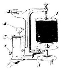
**Рис. 15**. Рис. 15. Кимограф: 1- цилиндр, 2- часовой механизм, 3- ось, 4- флюгер, 5- ключ
