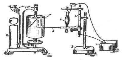
Рис.39. Установка для регистрации высоты одиночного мышечного сокращения под влиянием груза. (1.стимулятор УЭС-1, 2. универсальный штатив, 3.вертикальный миограф, 4.мышца лягушки, фиксированная за коленный сустав (сверху) и пяточное сухожилие (снизу), 5.подвижное плечо миографа, 6.кимограф, 7.барабан кимографа)
