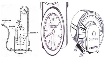
Рис. 117. Водяной спирометр и схема его строения
