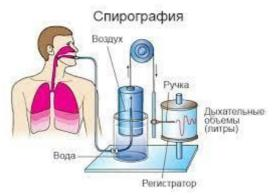
Рис. 116. Схема спирометра
