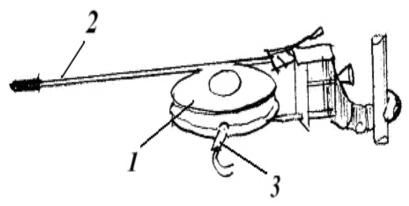
**Рис. 22**. Полиграф: 1-капсула Марея, 2-писчик, 3-металическая трубка
