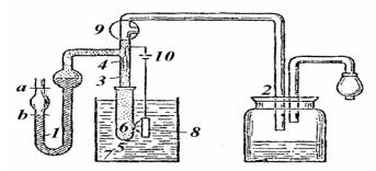
**Рис. 79.** Схема целлоскора: 1- ртутный манометр, 2 -система вакуума, 3- стекляный сосуд, 4- электрод, 5- пробирка, 6- каллибровочное отверстие, 7- стакан, 8- 2-й электрод, 9- кран, 10- источник тока
