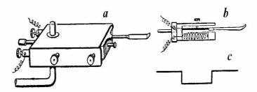
**Рис. 14.** Отметчик раздражения: а-внешний вид, b-схеме, с-отметка раздражения
