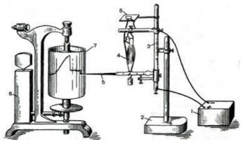
**Рис. 29.** Установка для работы с нервно-мышечным препаратом лягушки.
