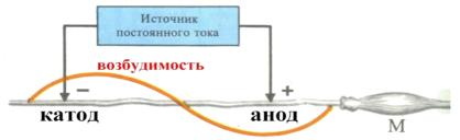
**Рис. 50.** Установка, изучающая полярное действие постоянного тока и электротон
