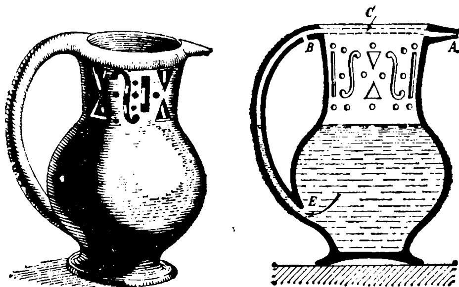
Рис. 63. Обманчивый кувшин конца XVIII века и секрет его устройства.
