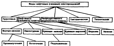
Рис.58. Схема классификации вод нефтяных и газовых месторождений
