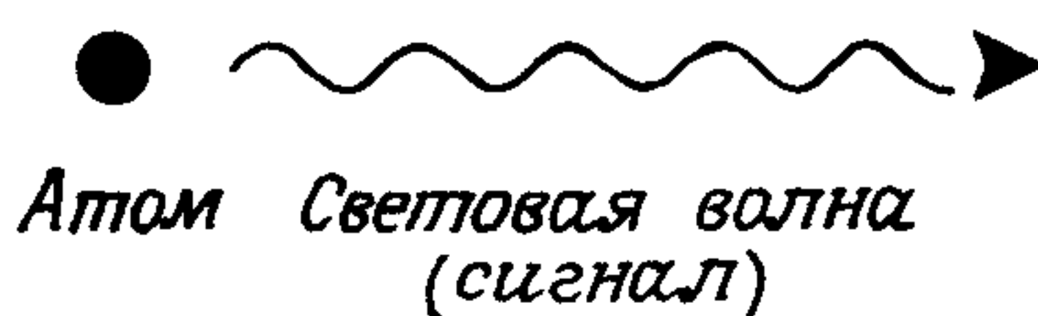
Рис. 1.29. Возбужденный атом испускает световую волну (сигнал).
