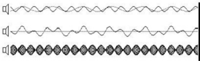
Рис.24 Так выглядит компьютерная модель, в которой источник колебаний изображён в виде динамика. Прямая и отражённая волны имеют равные частоты, но разные скорости, а потому и длины. Сложение этих волн даёт результирующую в виде биения. Если данный процесс рассматривать просуммированным во времени, то вырисовываются пучности и узлы, что и служит основанием говорить о стоячей волне.
