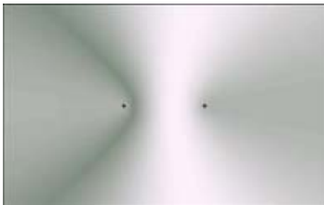
Рис.82 Сдвиг фаз между осцилляторами равен \Delta\varphi=45^\circ ( V=0 ), произошёл сдвиг стоячей волны вправо.
