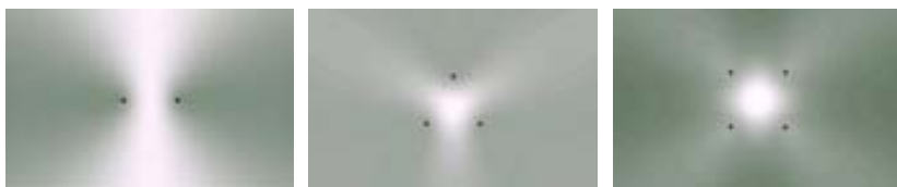
Рис.45 Картина распределения энергии: а – диполь; б – треугольник; в – квадрат. На рис.45в видно, что осцилляторы находятся в зонах неустойчивого равновесия
