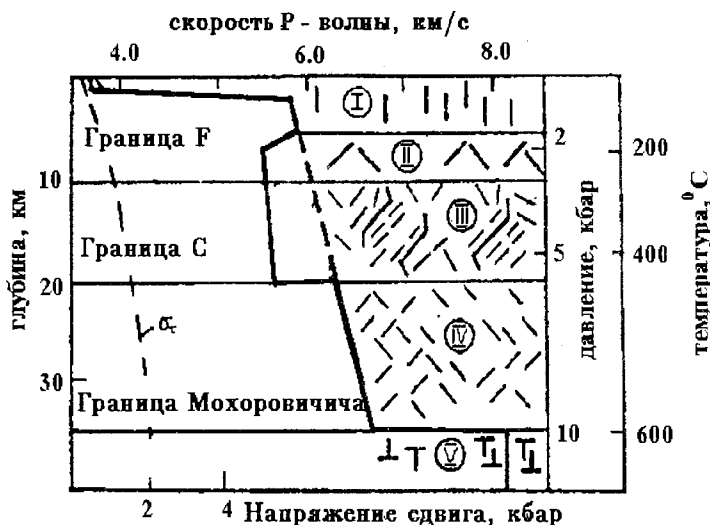
Рис. 6.6. Строение земной коры с границами F, С, М - Форша, Конрада и Мохоровичича (пунктир соответствует сплошным состояниям пород; точками дана линия напряжений сдвига, требуемых для тектонического разрушения пород) [90]
