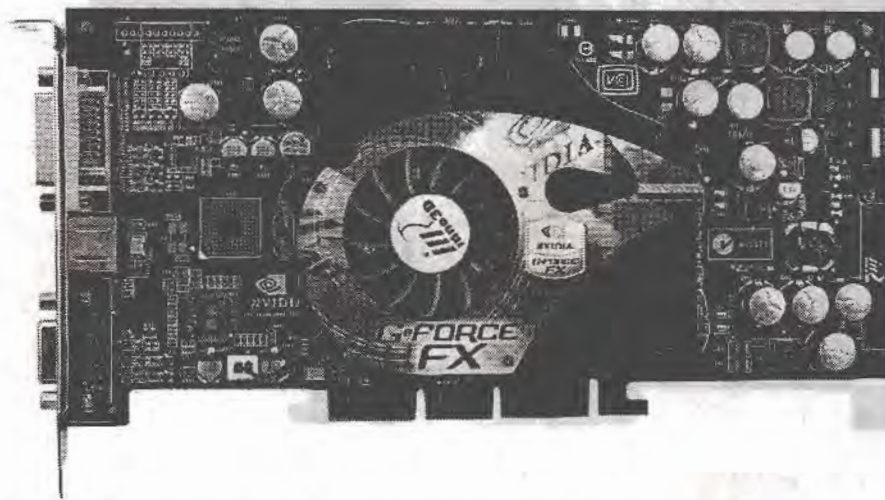
Рис. 7.2. Видеокарта Inno3D Tornado на базе основного набора микросхем GeForce FX 5700 Ultra
