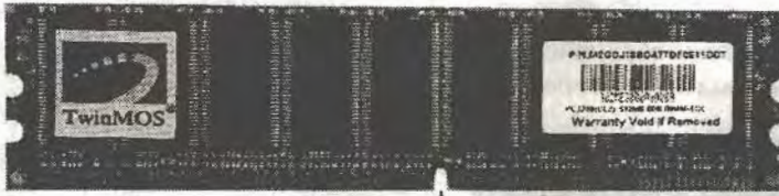
Рис. 20.9. Ключ на модуле памяти
