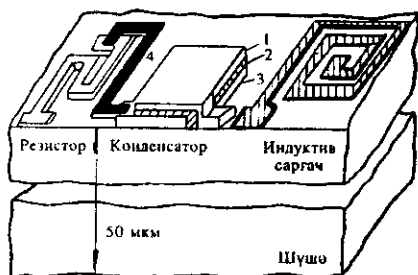
Шөкил 8.4. Тәбөгәли интеграл схемин элементләринин структуру: 1-үст лөвһө; 2-алт лөвһө; 3-диелектрик; 4-бирләшдиричи метал золаг
